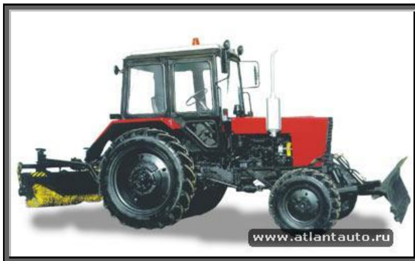
Рисунок 3.1. Общий вид плужно-щеточной машины
